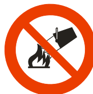
Prohibit apagar amb aigua
