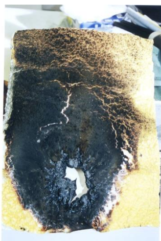
Diferències de comportament al foc (reacció al foc) en dues mostres de poliuretà.
