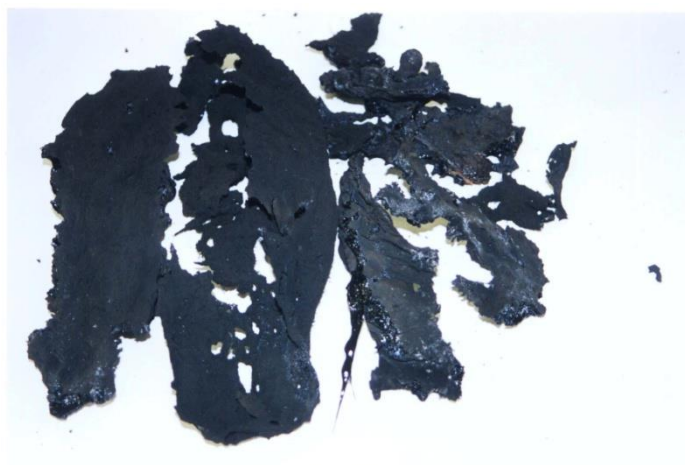
Diferències de comportament al foc (reacció al foc) en dues mostres de poliuretà.
