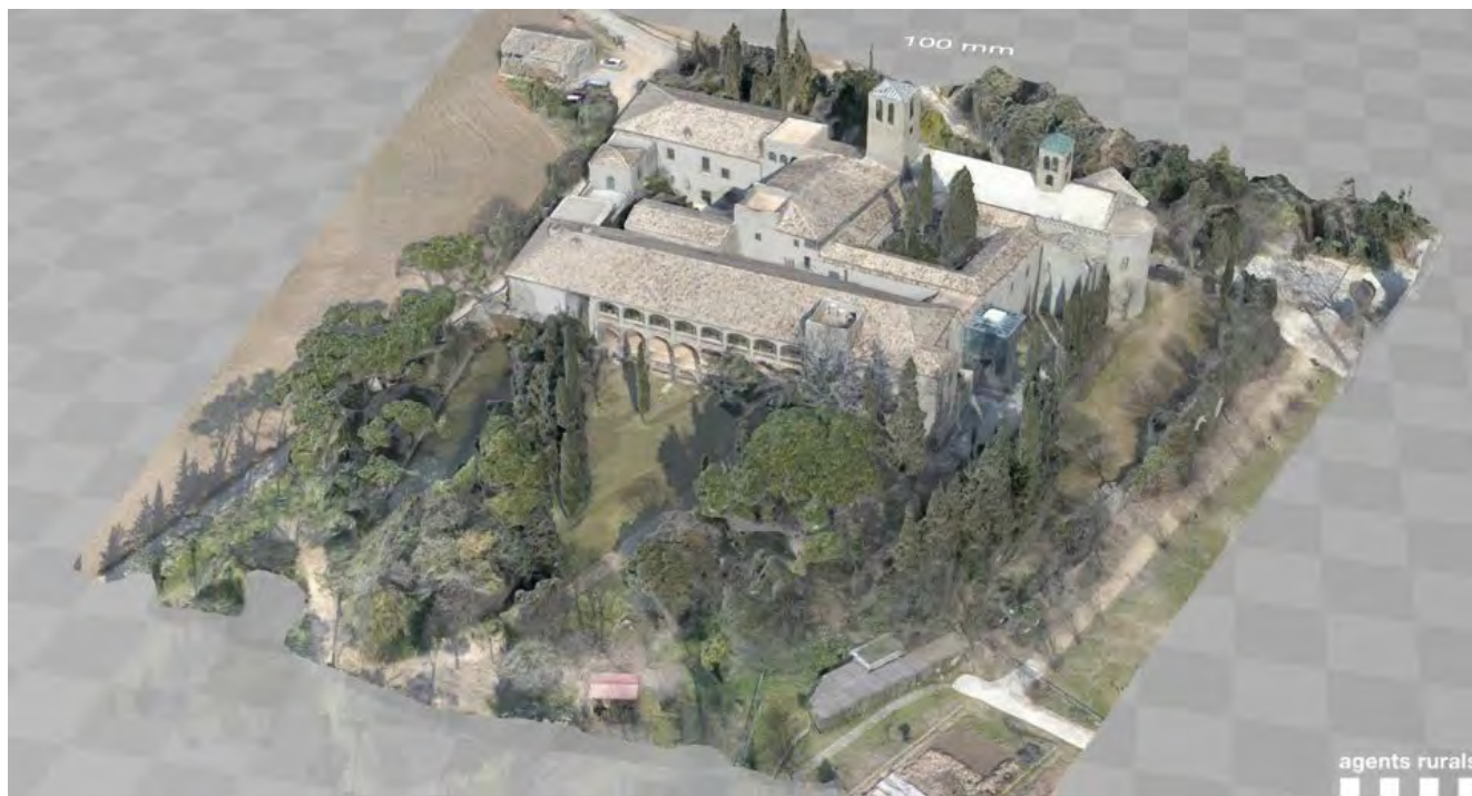
Figura 17. El resultat del treball fotogramètric 3D realitzat pel GSA-RPAS sobre el monestir de Sant Benet del Bages.
