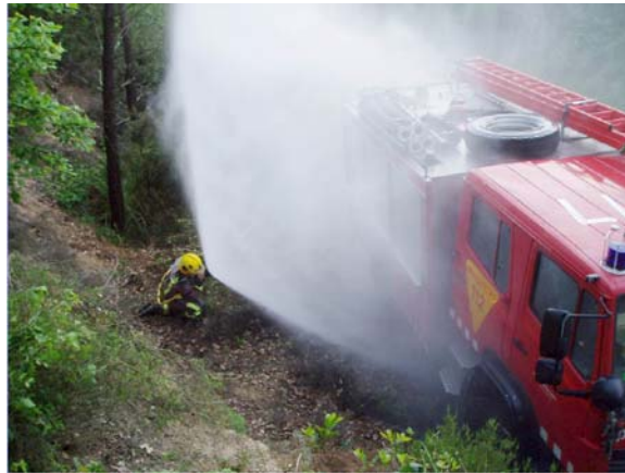
Maniobra de defensa amb llança de Ø 25 a la zona de supervivència ("ombra" de l'autobomba)
