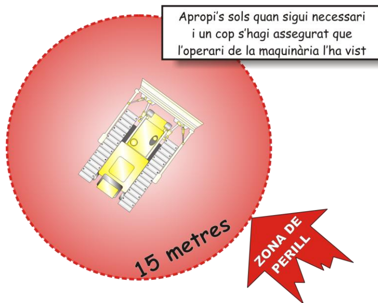
Figura 12. Zona de seguretat que cal mantenir sempre al voltant de la màquina
