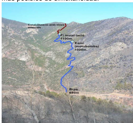
Imagen 2: Incendio forestal de Gerri de la Sal, marzo 2012. Maniobra combinada con EAMI 1 o Básico. Instalación BRP + EAMI 1 + herramientas manuales. Fuente: Bomberos
