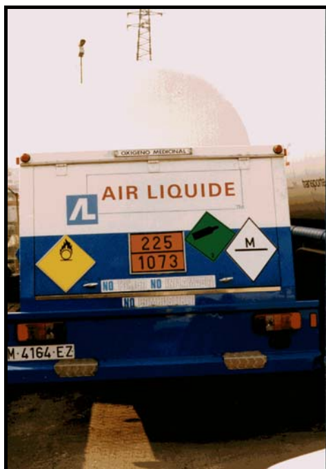
Fig. 10: Vista posterior d'un vehicle que transporta oxigen líquid molt refrigerat. Vegeu-hi la placa taronja i les etiquetes de perill.
