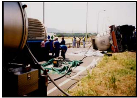
Fig. 35 i 36: accident d'un camió cisterna que transportava combustible. Detall de les operacions de transvàs del material. Font: Incidentes en el transporte de mercancías peligrosas en la CA.PV años 1996-2000 . Servicio de Intervención. Dirección de Atención de emergencias. Departamento de Interior. Gobierno vasco.
