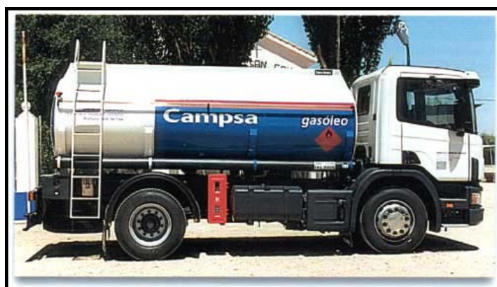
Fig. 15 i fig. 16: Diferents vistes d'un camió cisterna que transporta gas-oil. Pareu atenció a la senyalització: placa taronja i etiqueta de perill a la part posterior i etiqueta de perill a la part lateral.
