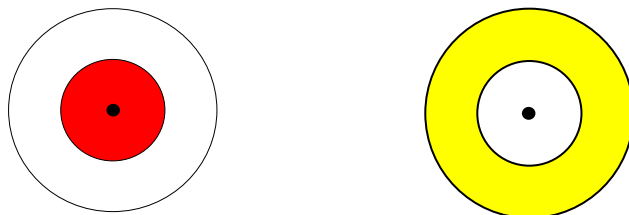
Fig. 47: Representació esquemàtica de la zona d'intervenció (en vermell) i la zona d'alerta (en groc) d'un accident amb productes químics, originat en un punt concret.
