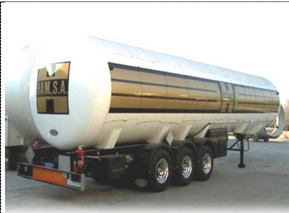
Fig. 24: fotografia d'una cisterna semirremolcada autoportant, en aquest cas, es tracta d'una cisterna per a transportar líquids criogènics, amb aïllament exterior. Font: Ventosa, Albert. Cisternes per al transport de mercaderies perilloses per carretera.
