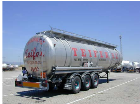
Fig. 25: fotografia d'una cisterna semirremolcada autoportant. Font: Ventosa, Albert. Cisternes per al transport de mercaderies perilloses per carretera.
