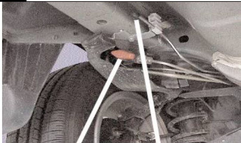
Figura 1.13 Situació de la vàlvula de tall manual i la vàlvula d'alleujament de pressió (Honda Civic GX)
