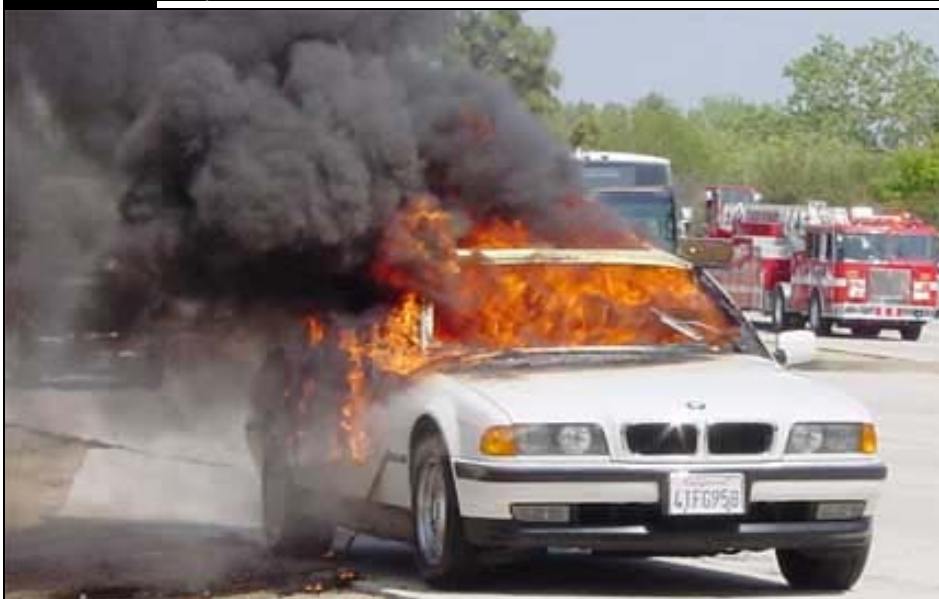
Figura 1.16 Incendi d'un vehicle turisme impulsat per GNC, que no afecta el gas o els recipients contenidors.
