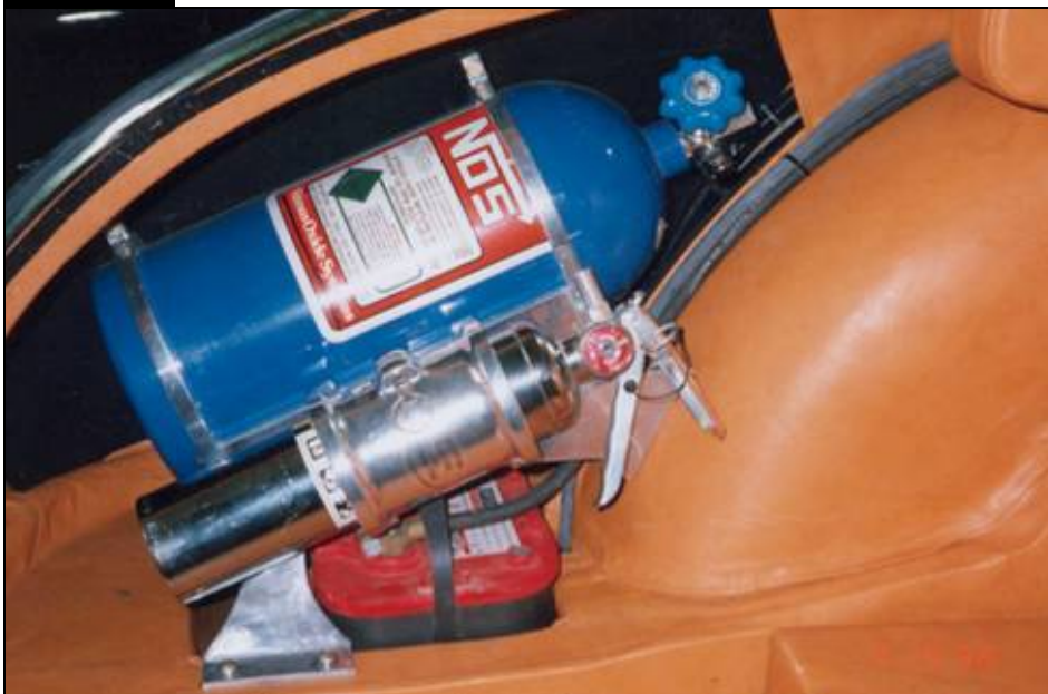
Figura 1.4 Cilindre d'òxid nítrós al costat d'un extintor
