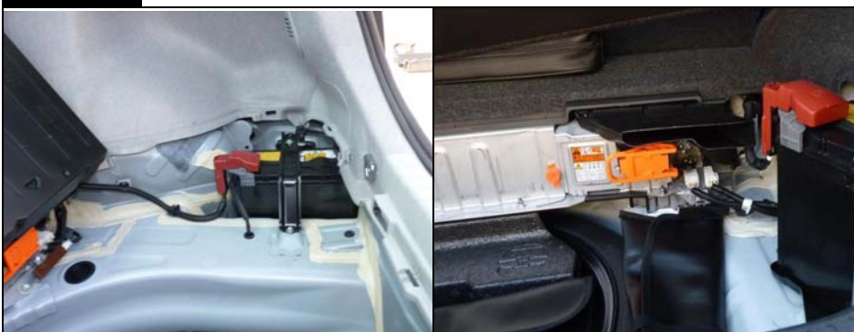
Figura 1.29 Connector de bateria VH i de bateria de 12V: a l'esquerra, Toyota Auris; a la dreta, Honda Prius.
