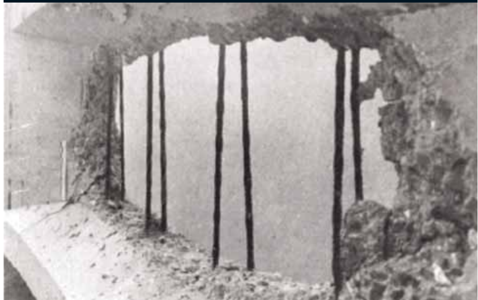
FIGURA 1.29. Fenomen de l'esclatament del formigó en l'ànima d'una biga pretensada (Kordina, 1965)
