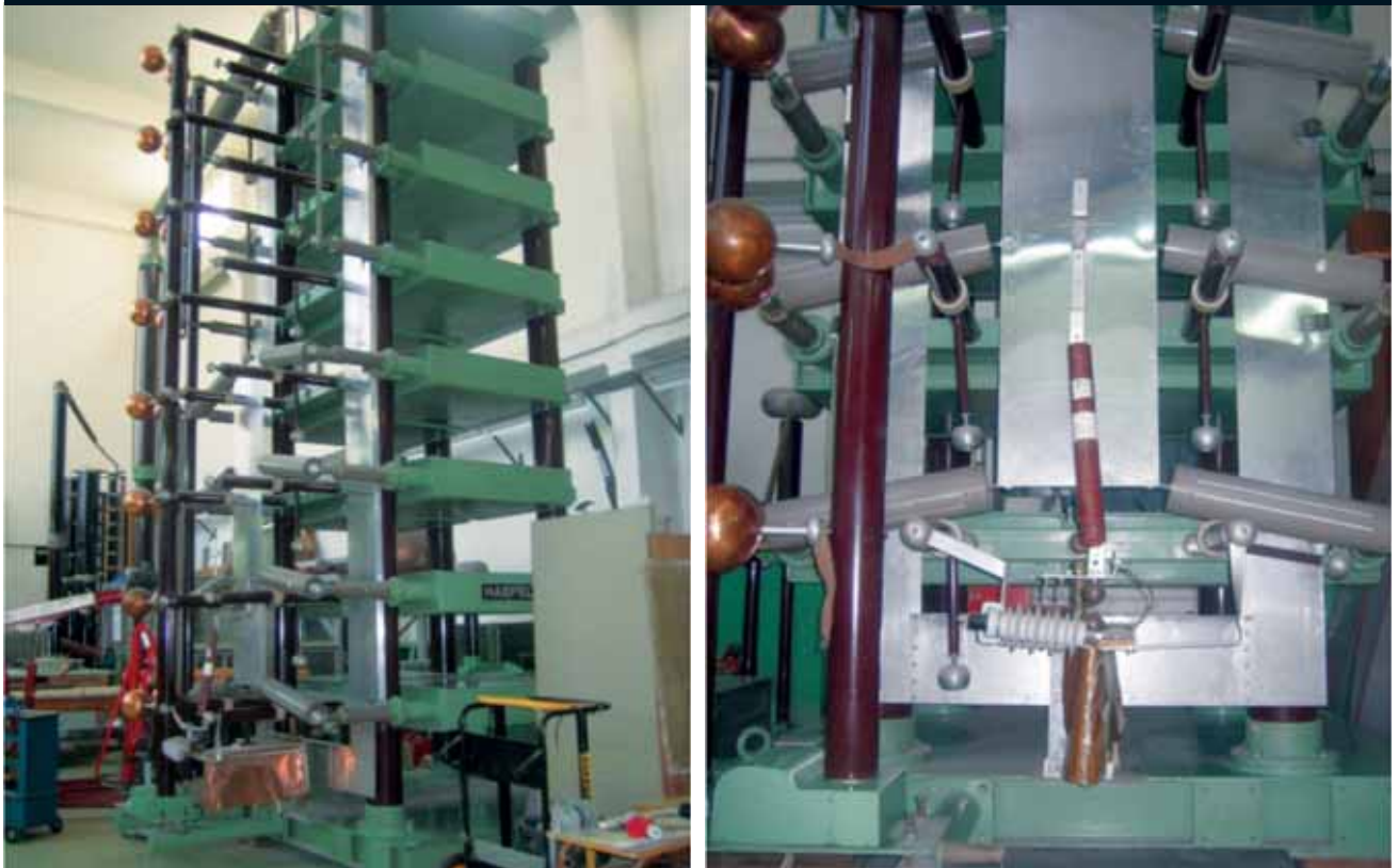
FIGURA 5.31. Plataforma d'assaig de corrent d'impuls tipus llamp
