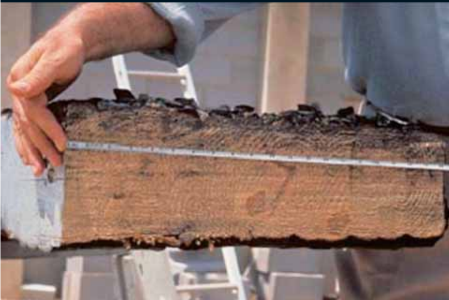
FIGURA 1.31. Carbonització superficial de la fusta en forma de pell de cocodril
