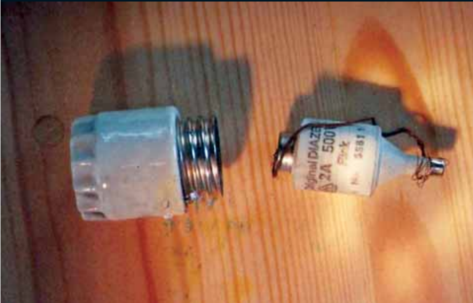
FIGURA 3.2. Un fusible al qual se li ha practicat el pont
