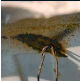
FIGURA 3.7. Detall del cable en contacte amb la planxa de la rentadora
