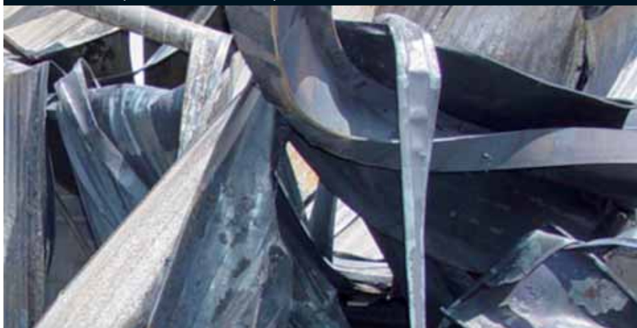
FIGURA 1.2. Bigues d'acer deformades per l'efecte d'un incendi; les zones de color gris blavós són les que han rebut més temperatura
