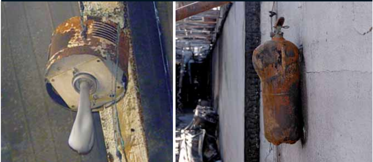
FIGURA 1.6. La part més deformada de la bombeta i l'extintor indicarà la procedència de la calor
