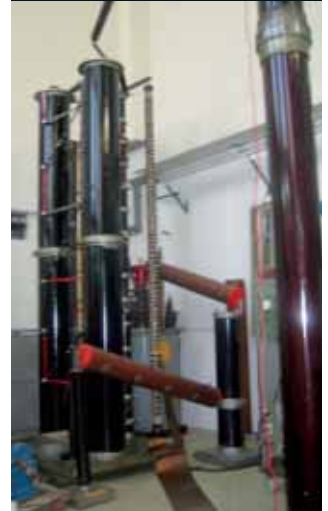
FIGURA 5.30. Plataforma d'assaig de tensió d'impuls tipus llamp
