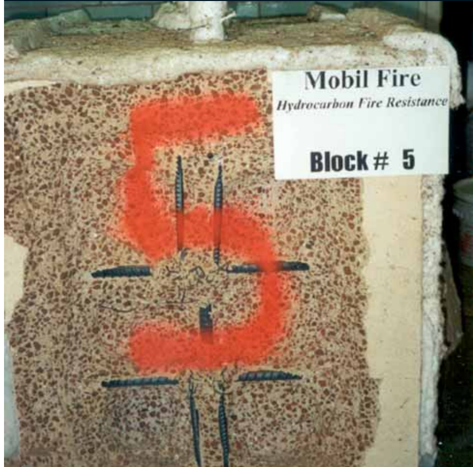
FIGURA 1.28. Fenomen de l'esclatament del formigó en un bloc sotmès a un foc normalitzat d'hidrocarburs en una sola cara. Les armadures d'acer queden al descobert després del despreniment del formigó (Bilodeau, 2004)
