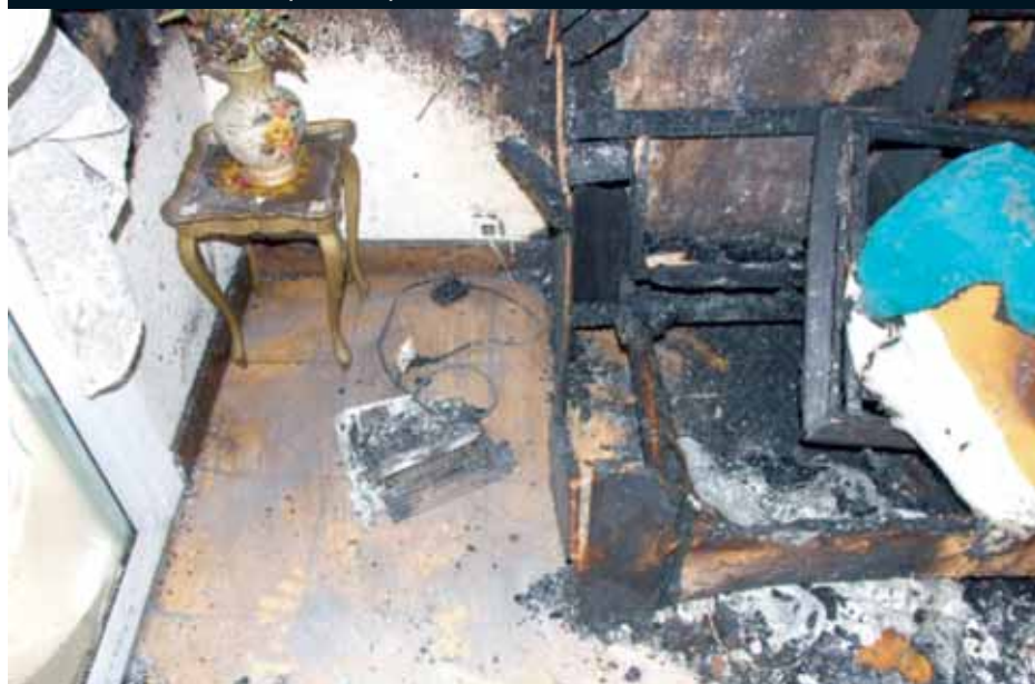
FIGURA 4.31. Incendi provocat per contacte directe entre una cortina i una estufa
