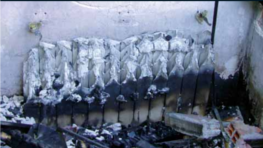
FIGURA 1.3. Un radiador d'alumini fos indicarà la temperatura mínima a la qual ha estat sotmès (660 °C)
