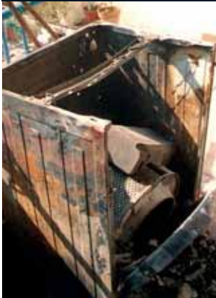
FIGURA 3.6. A la part superior de la rentadora es pot apreciar la zona on el cable ha provocat el curtcircuit
